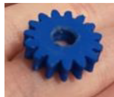
L'un des 2 engrenages créés avec l'imprimante 3D
